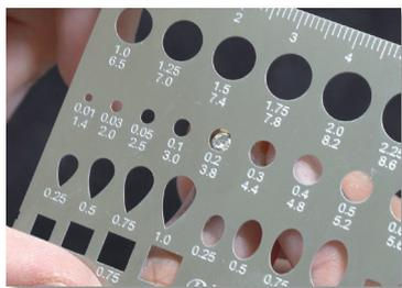
ダイヤモンドをゲージにあてるだけで簡単に概算カラットを測定できます
