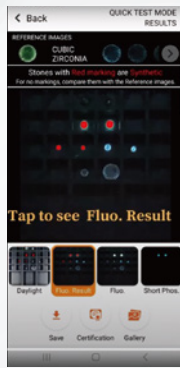
判定画像 CVD/HPHT合成ダイヤモンドの場合、赤く色が付きます
